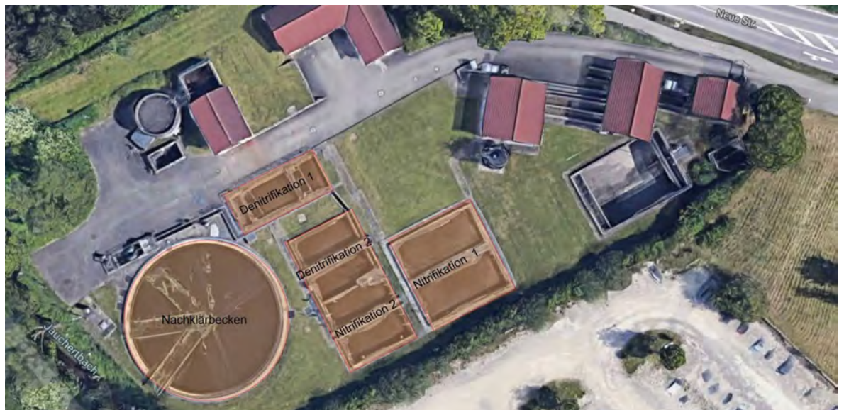
Abb. 1: Übersichtsplan Kläranlage Bissingen - Nabern [Quelle google-maps] mit den in der Studie bewerteten Bauwerken
