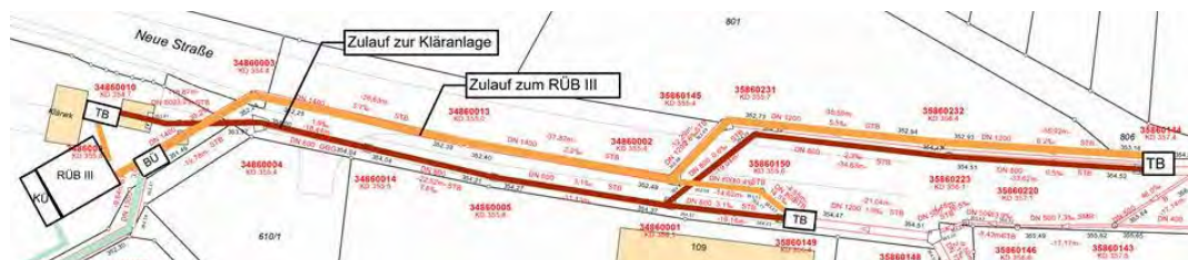
Abb. 2: Bestehende Zulaufsituation zum RÜB III auf der Kläranlage Bissingen-Nabern
