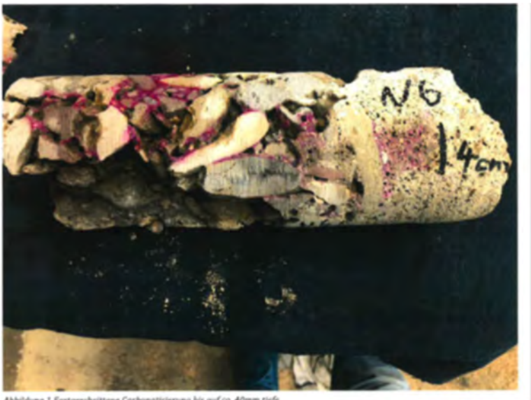
Abbildung 1. Eiertombrittene Carbonatitvarnna bis auf ca. 40cm Tiefe
