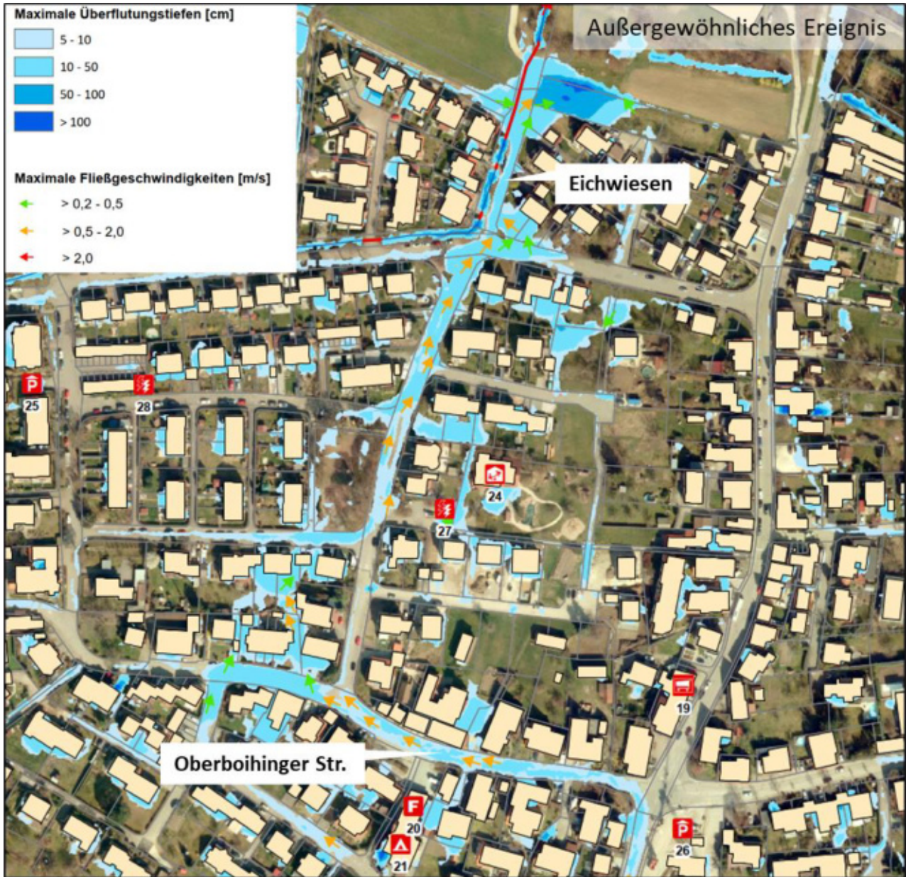
Abbildung 10.2 Außergewöhnliches Abflussereignis im Bereich der Oberboihinger Straße bis Eichwiesen
