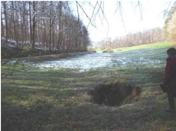
**Abbildung 73: Blick vom Waldrand über den unterirdisch verlaufenden Tobelbach, zu sehen ist der erste Bodeneinbruch (Abschnitt 10).**
