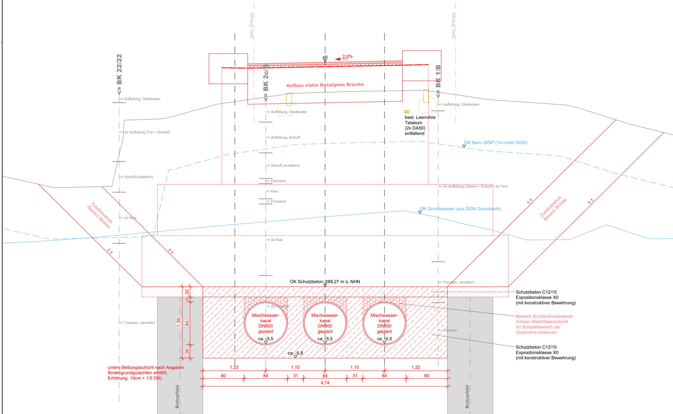
untere Bettungsschicht nach Angaben Bodengrundgutachten erhöht, Erhöhung: 10cm + 1/5 DN)
